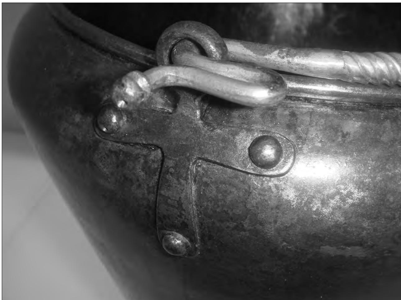
Fig. 7 Particolare del manico della situla Man. 5. Si notano ritocchi eseguiti sulla cera, soprattutto all'attacco del motivo a tortiglione. Ciò dimostra che il manico è stato prodotto in matrice da un modello in cera su cui il motivo a tortiglione era già presente.
