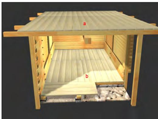
Fig. 23 Bressanone, Loc. Rosslauf: abitato. Ric. grafica; visione d'insieme del pavimento superiore (a) e di quello inferiore (b) in abete rosso. L'assetto originale delle assi è stato dedotto dalla loro posizione nei crolli.
