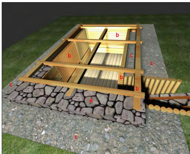
Fig. 7 Bressanone, Loc. Rosslauf: abitato. Ric. grafica; poggiate sopra i muri in pietra (a), sui lati Est, Ovest, Nord, venne costruita una struttura parietale autobloccante in legno (b); al loro esterno fu gettato del materiale ghiaioso drenante (c).
